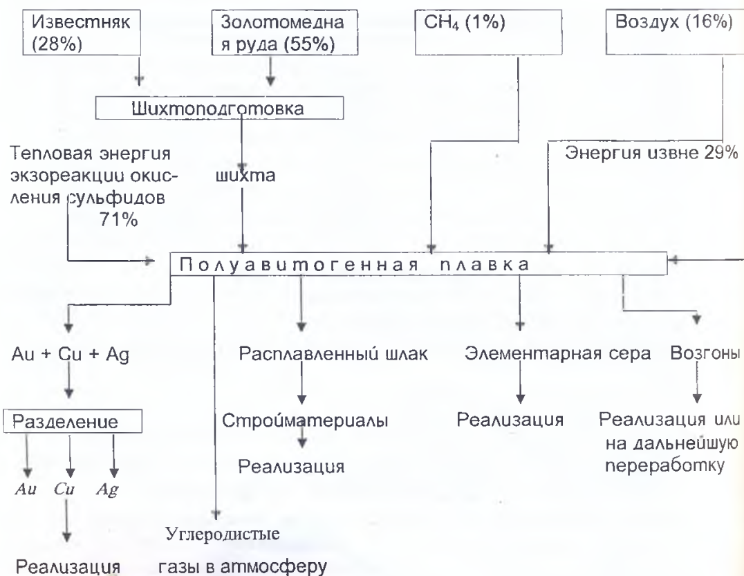
Рис.1. Принципиальная технологическая схема полуавтогенной плавки Дрмбонской руды.
